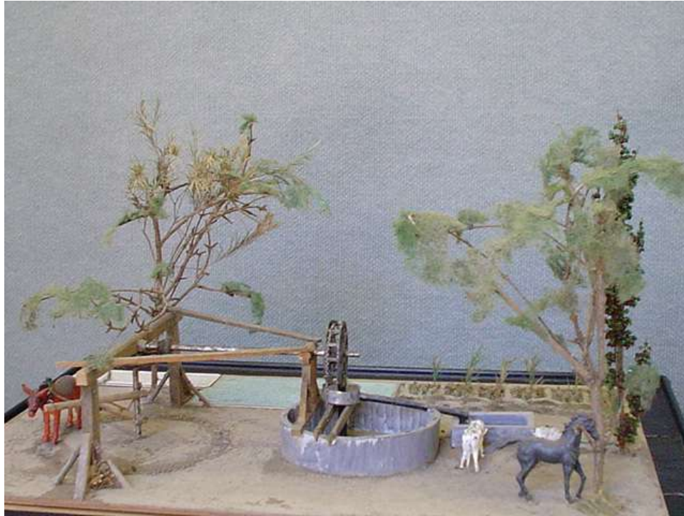
Μακέτα. Το μαγκανοπήγαδο ή (τσάρκι) για άρδευση νερού και πότισμα του λαχανόκηπου με τη χρήση ενός αλόγου
